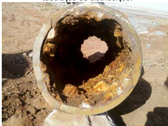
Figura 162. Vista de incrustação moderada em tubulação de distribuição.
