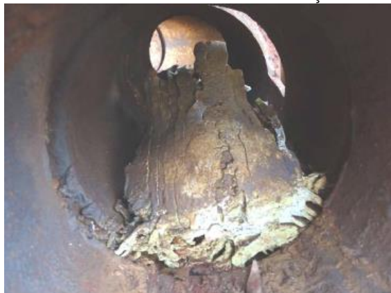
Figura 164. Vista de incrustação pela utilização de chumbo na bolsa da tubulação
