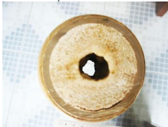
Figura 165. Vista de obstrução severa em tubulação de cimento amianto.
